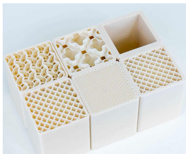
Im Material-Extrusions-Verfahren gedruckte Füllstrukturen für leichte und dennoch stabile Konstruktionen –
