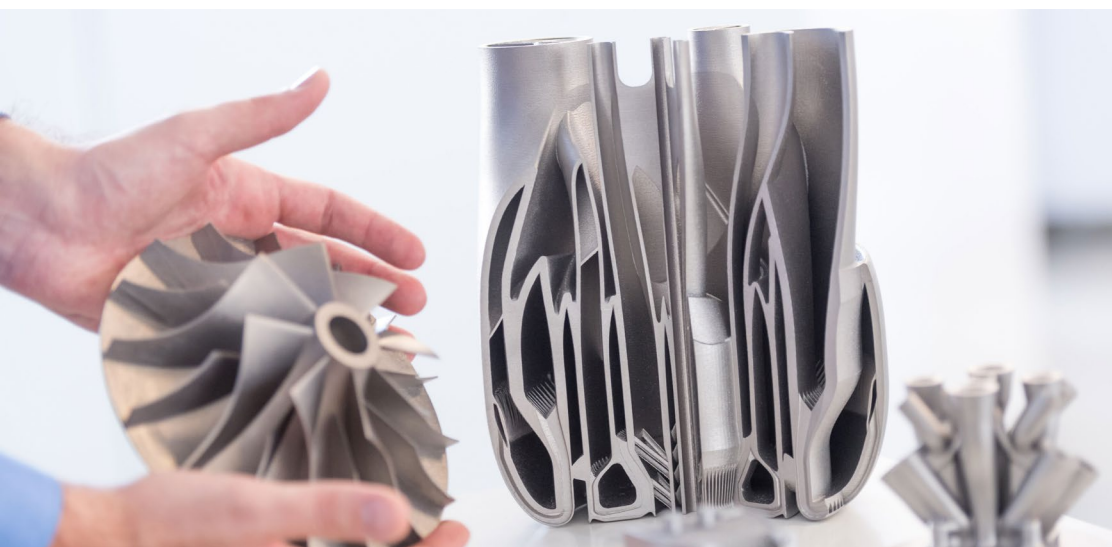
Im Powder-Bed-Fusion-Verfahren können aus Metallen oder Kunststoffen komplexe Objekte entstehen – Quelle: EOS
