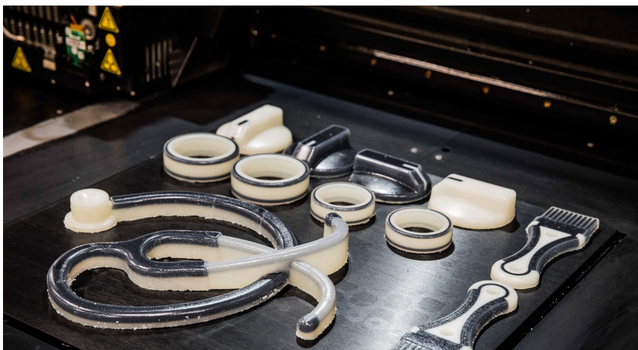
Durch lösliche Stützstrukturen werden Bauteile frei im Raum gehalten – Quelle: protolabs.com
